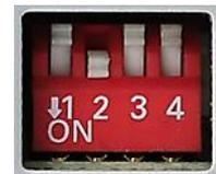
Dip Position "unten" ist ON und Position "oben" ist OFF.
