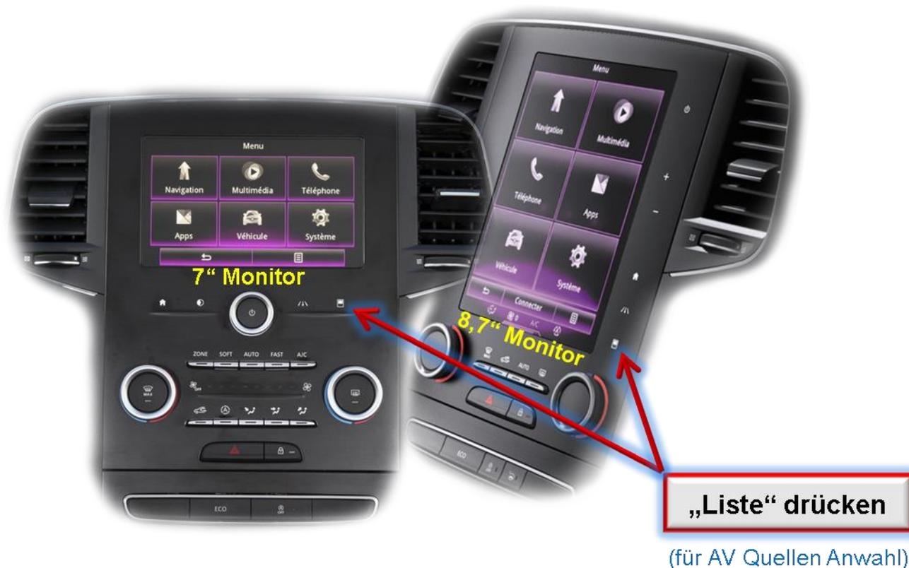
Die Listen-Taste der Infotaimenteinheit schaltet den Eingang vom Werksvideo zu den eingespeisten Videoquellen um. Wenn alle Eingänge per Dip Switch Einstellung aktiviert sind, ist die Reihenfolge wie folgt:
