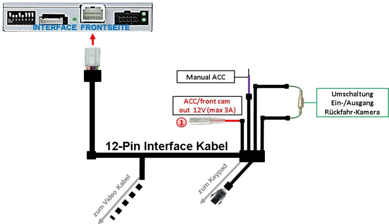
① Der rote Stromversorgungsausgang **ACC/front cam out 12V (max 3A)** kann zur Stromversorgung einer externen Quelle genutzt werden und hat je nach Stellung von Dip Schalter 1 (der schwarzen 8 Dips) eine andere Belegung:
