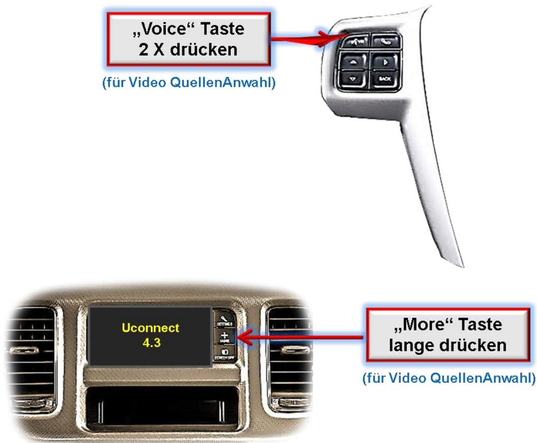
Zum Umschalten der Video Quellen kann die **VOICE** Taste am Lenkrad oder beim 4.3 Zoll Monitor die **MORE** Taste verwendet werden.
