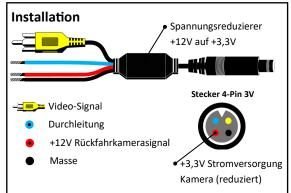
Hinweis: Bei Stromversorgung über Rückfahrleuchte empfehlen wir die Installation eines Relais zwischen Stromversorgung der Rückfahrleuchte und Kamerastromversorgung, um eine stabile und störungsfreie Stromversorgung zu gewährleisten und Fehlermeldungen im Bordcomputer zu vermeiden.
