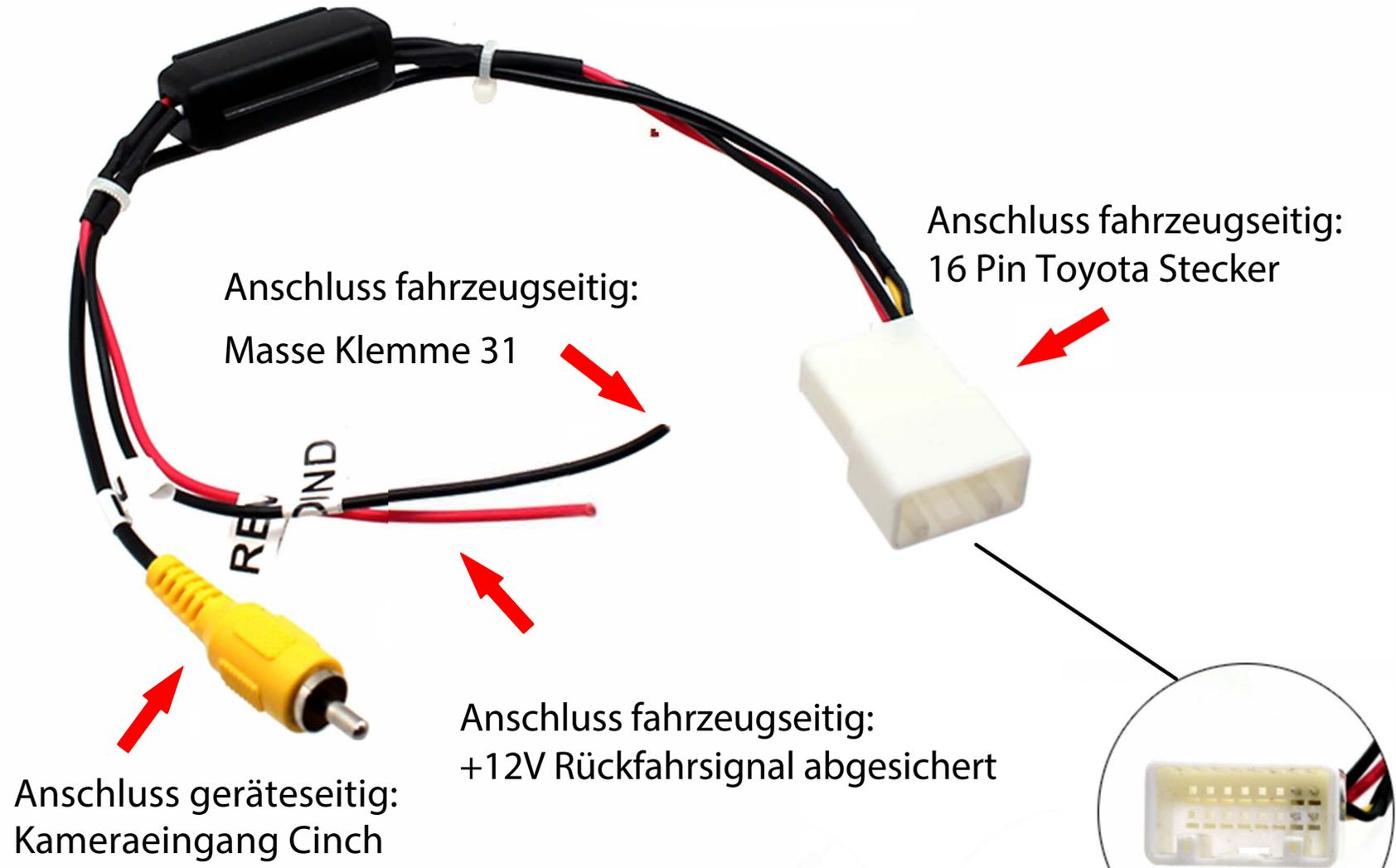
Ausgang +6V: Kameraspeisespannung: Vor Installation den 16 Pin Toyota Stecker auf richtige fahrzeugseitige Belegung durch Messen prüfen
