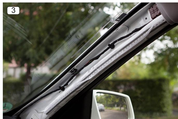
3. Entfernen Sie das Trägerblatt (Fähnchen 1) der Folienantenne (Nr. 1) und kleben Sie diese bündig zur Keramiklinie.
