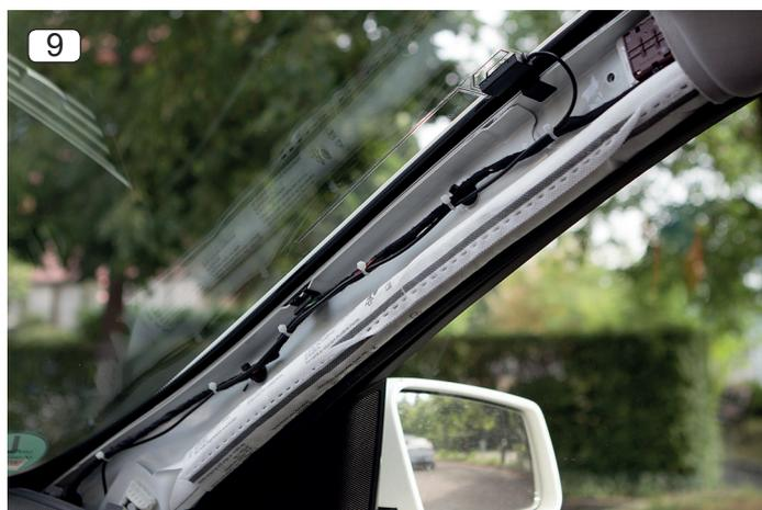
9. Befestigen Sie das Antennenkabel mit Kabelbindern an den bereits bestehenden fahrzeugseitigen Kabelsträngen.
