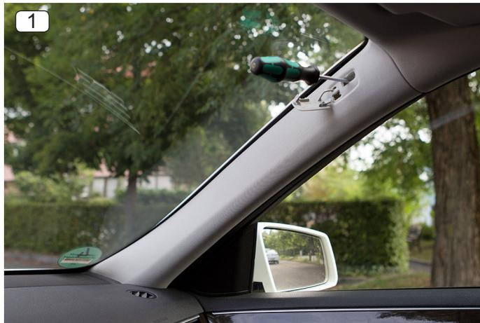
1. Entfernen Sie die A-Säulenabdeckung an Ihrem Fahrzeug. Die Abdeckung wird mit speziellen Clips gesichert. Meistens versteckt sich hinter einer Abdeckung im oberen Bereich der A-Säule noch eine Schraube.
