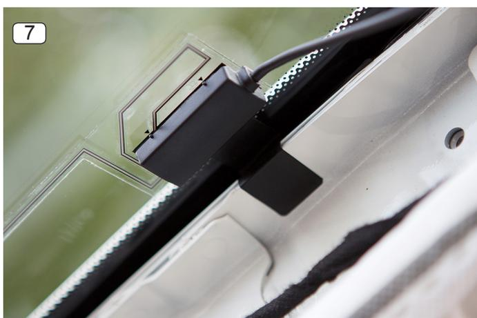
7. Entfernen Sie die Schutzfolie von dem Masseblatt und kleben Sie dieses auf die A-Säule (Metallteil).
