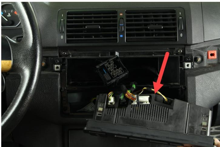
6. Lösen Sie durch Druck von Hinten das Klimabedienteil aus der Mittelkonsole und trennen Sie alle Anschlüsse hinten am Klimabedienteil.
