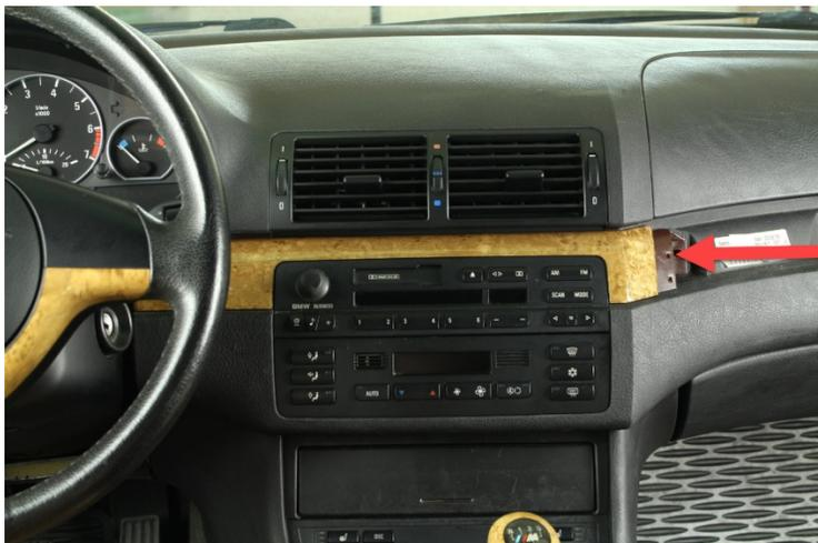
3. Lösen Sie mit dem beiliegenden Kunststoffentriegelungswerkzeug (Nr. 10) die Zierleiste oberhalb des Originalradios. Hierzu müssen Sie das Kunststoffentriegelungswerkzeug seitlich ansetzen und die Zierleiste vorsichtig heraushebeln.
