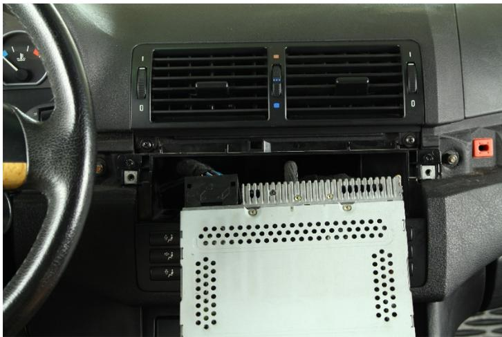
5. Entnehmen Sie das Originalradio und trennen Sie alle Anschlüsse hinten am Gerät.
