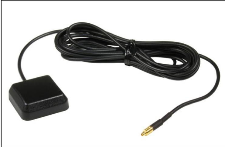
11. Montieren Sie die GPS-Antenne (Nr. 2) an einer geeigneten Stelle und achten Sie darauf, dass der GPS-Empfang nicht durch die Abschattung von metallischen Fahrzeugteilen negativ beeinflusst wird (Wärmeschutzverglasung etc.). Verlegen Sie das Anschlusskabel anschließend in den Radioschacht.
