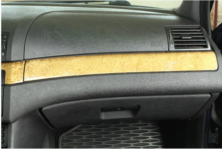
1. Lösen Sie mit dem beiliegenden Kunststoffentriegelungswerkzeug (Nr. 10) die Zierleiste auf der Beifahrerseite.
