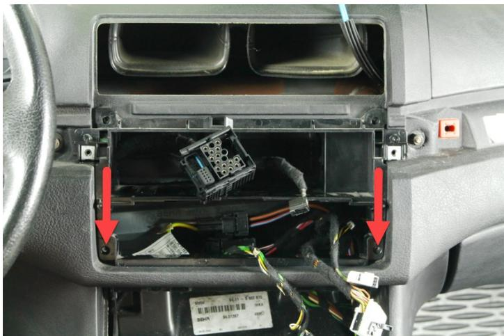
9. Lösen Sie die letzten beiden Befestigungsschrauben des Plastikrahmens und entfernen Sie diesen vorsichtig aus dem Radioschacht.
