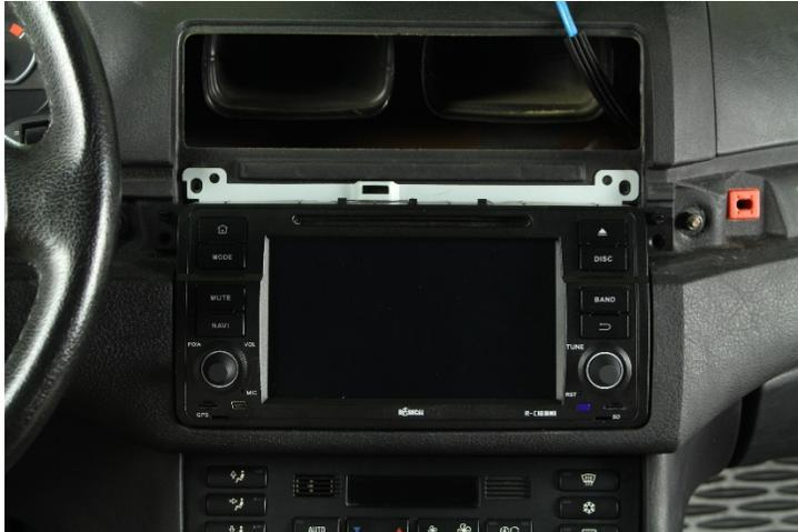
14. Verlegen Sie die diversen Anschlusskabel des Radical-Geräts sorgfältig im unteren Bereich der Radioschachts. Schieben Sie anschließend das Radical-Gerät vorsichtig und mit dosierter Kraftaufwendung zurück in den Radioschacht.
