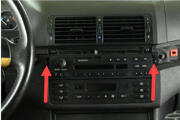
4. Lösen Sie mit Hilfe eines Kreuzschraubenziehers die beiden seitlichen Befestigungsschrauben des Originalradios.
