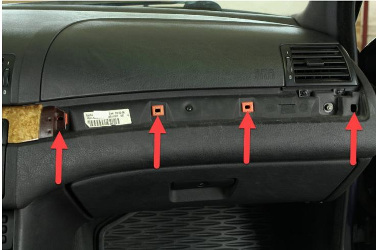
2. Hierzu müssen Sie das Kunststoffentriegelungswerkzeug an den markierten Punkten von unten an der Zierleiste ansetzen und diese dann vorsichtig heraushebeln.
