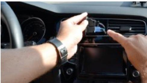
4. Entnehmen Sie die Schaltereinheit, um dann die Radioblende zu entfernen.
