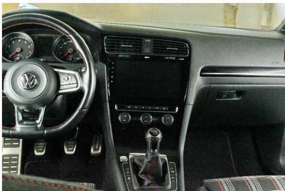
11. Verlegen Sie die diversen Anschlusskabel des Radical-Geräts sorgfältig im unteren Bereich der Radioschachts. Schieben Sie anschliessend das Radical-Gerät vorsichtig und mit dosierter Kraftaufwendung zurück in den Radioschacht. Drücken Sie den R-C10VW2 soweit nach innen, bis Sie hören wie die Verriegelung einklickt.
