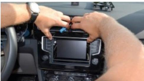
5. Greifen Sie dazu in die Öffnung der zuvor entfernten Schaltereinheit, um die Radioblende mit einem kräftigen Ruck nach vorne zu lösen. Bei der Entfernung der Radioblende müssen Sie darauf achten, dass die Steckverbindungen der Radioblende am Übergang zum Kombiinstrument vorsichtig entriegelt werden.
