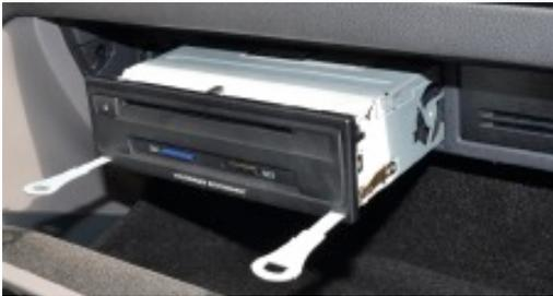
7. Falls Ihr Fahrzeug im Handschuhfach mit einem Steuergerät für die Informationselektronik ausgestattet ist, müssen Sie dieses zuerst entfernen. Verwenden Sie die Entriegelungsbügel und ziehen Sie das Steuergerät soweit heraus, um alle Stecker an der Rückseite zu entriegeln und entfernen Sie das Steuergerät.
