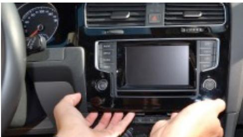
2. Ziehen Sie die Radioblende an der unteren Seite leicht nach vorne, um sie von der Multimediabedieneinheit zu lösen.
