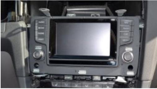
6. Verwenden Sie die im Lieferumfang des Radical-Gerätes enthaltenen Entriegelungsbügel (No. 15), um die Multimedia Bedieneinheit zu entfernen. Entriegeln Sie anschließend alle Stecker an der Rückseite und entfernen Sie die Multimediabedieneinheit
