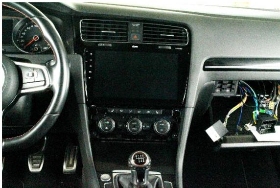
10. Verbinden Sie das jeweilige Hauptanschlusskabel (Nr. 11) des Radical-Geräts (Nr. 1) mit dem Stecker des Fahrzeugs und schliessen Sie den Verriegelungsmechanismus des Steckers. Verbinden Sie anschliessend das CAN-Bus Interface (Nr. 12) mit dem Hauptanschlusskabel. Verbinden Sie alle zuvor in den Radioschacht verlegten Kabel und die originalen Antennenkabel mit dem Radical-Gerät (Nr. 1).
