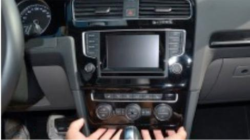
1. Öffnen Sie den Aschenbecher bis zur Hälfte, damit Sie die Blende der Klimabedieneinheit von Hand entfernen können.
