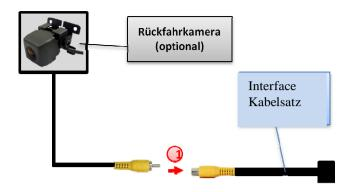
Den Video-Chinch Stecker der Nachrüst-Rückfahrkamera mit der Video-Chinch-Buchse des Interface Kabelsatzes verbinden.
