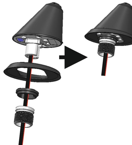
Jetzt alle Verbindungen für einen ersten Funktions-Test herstellen. Im Menü des DAB-Tuners muss die Phantomspeisung aktiviert werden, damit die Funktion von FM und DAB gewährleistet wird. Alternative ist die Speisung über den Remoteausgang des Radios möglich. Eine Verlängerungsleitung für die rote Spannungslitze ist nicht im Lieferumfang. Sie muss bei Phantomspeisung nicht angeschlossen werden. Ist der Test erfolgreich, kann die Grundplatte für die Endmontage vorbereitet werden.
