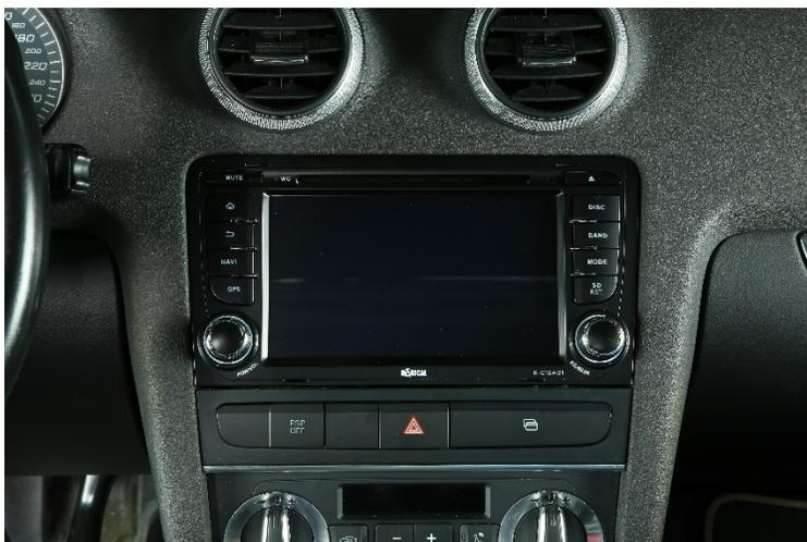
7. Verlegen Sie die diversen Anschlusskabel des Radical-Geräts sorgfältig im unteren Bereich der Radioschachts. Schieben Sie anschließend das Radical-Gerät vorsichtig und mit geringer Kraftaufwendung zurück in den Radioschacht. Drücken Sie den R-C11AD1 soweit nach innen, bis Sie hören wie die Verriegelung einklickt. Der Einbau des R-C11AD1 ist hiermit beendet.
