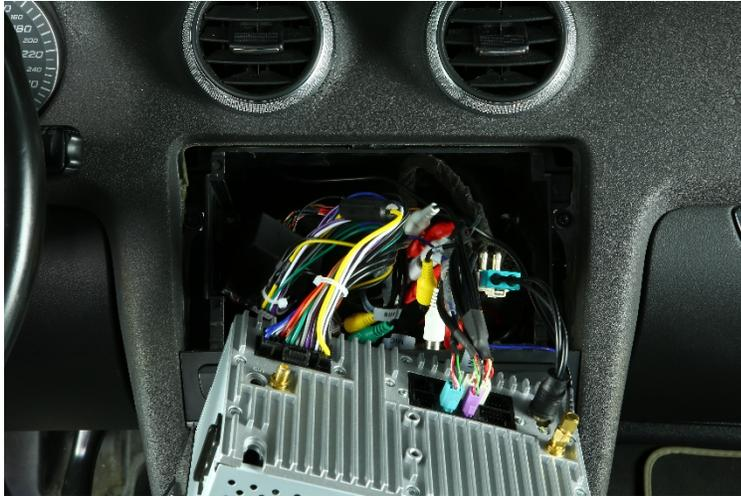
6. Verbinden Sie das jeweilige Hauptanschlusskabel (Nr. 11/12) des Radical-Geräts (Nr. 1) mit dem Quadlockstecker/ISO des Fahrzeugs und schließen Sie den Verriegelungsmechanismus des Steckers. Verbinden Sie anschließend das CAN-Bus Interface (Nr. 14) mit dem Hauptanschlusskabel. Verbinden Sie alle zuvor in den Radioschacht verlegten Kabel und die originalen Antennenkabel mit dem Radical-Gerät (Nr. 1).
